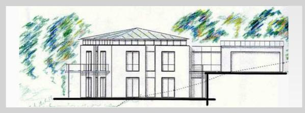
EINFAMILIENHAUS, ZWEIGESCHOSSIGE HANGBEBAUUNG, EG(UG) + DG(EG) HAUPTBAU ALS WÜRFEL, ANGEGLIEDERTER RIEGEL. GRUNDFLÄCHE  $\sim$  9,0 m x 9,0 m +  $\sim$  15,0 m x 6,5 m. INSGESAMT  $\sim$  360 m² NUTZFLÄCHE
